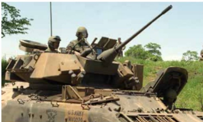
Een M2A1 voorzien van een Bushmaster kanon met gladde loop en coaxiaal de M240C in een stevig affuit; de 7,62mm loop is nauwelijks zichtbaar. Het gaat hier om het trainingsgedeelte van "Exercise Shadow Hawk '87", een fase van oefening "Bright Star '87". Het doel was de procedures die werden gebruikt om Amerikaanse tactische en logistieke krachten in te zetten, te testen.
