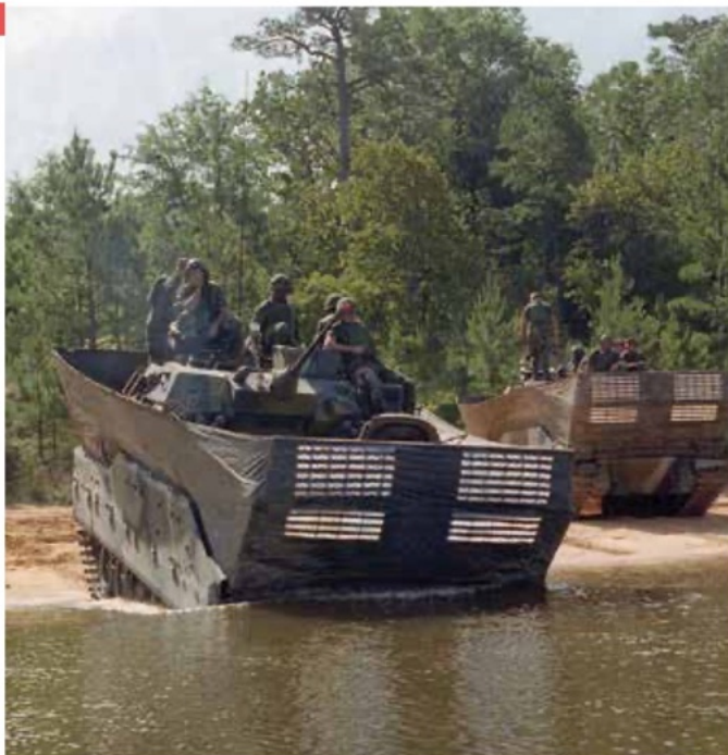
Een M2 Bradley rijdt Victory Pond (Fort Benning, Georgia, Amerika) in, vaart een rondje en rijdt er weer uit tijdens een oefening. Let op de opgeklapte boegplaat en scherm.
