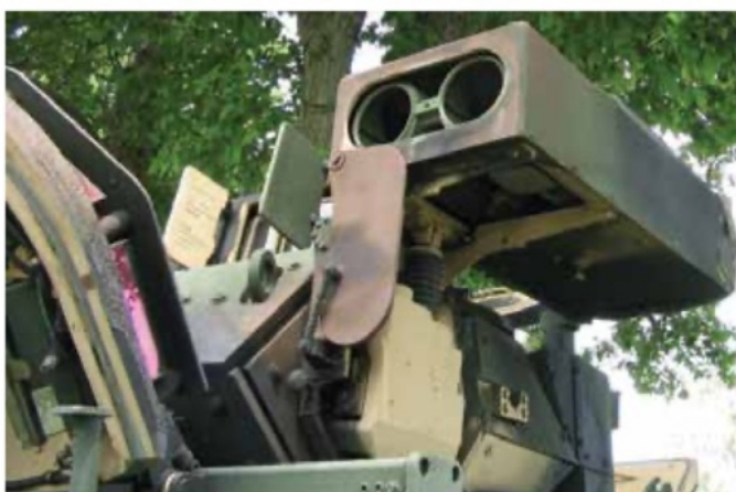
TOW 2 launcher op een M3A3 Bradley. De afsluitklep van de doos is rond aan de onderzijde. Op het A0 model heeft die een lip. Tamiya heeft dit goed weergegeven op zijn A0 modellen.
