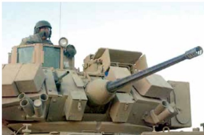
Het nieuwe affuit voor de M240C, gemonteerd op een M2A3 met ERA blokken. Er is duidelijk meer zichtbaar van de loop.
