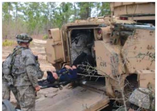
Tijdens oefeningen (2007) in Fort Stewart wordt een gewonde ingeladen in een Bradley. Let op de periscopen in het luik, waaraan te zien is dat het een M3 is.
