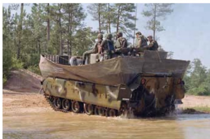
Een M2 Bradley rijdt Victory Pond (Fort Benning, Georgia, Amerika) in, vaart een rondje en rijdt er weer uit tijdens een oefening. Let op de opgeklapte boegplaat en scherm.
