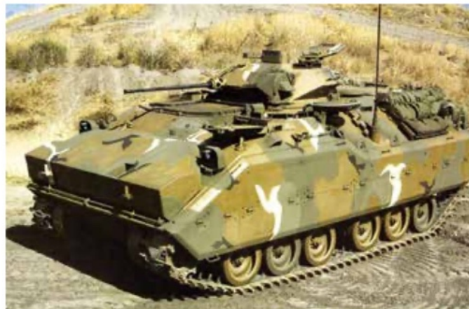
XM 723 prototype uit 1975, met 20mm kanon. De latere 25mm Bushmaster was nog niet beschikbaar. Duidelijk zijn in de romp de contouren van de latere Bradley te herkennen.
